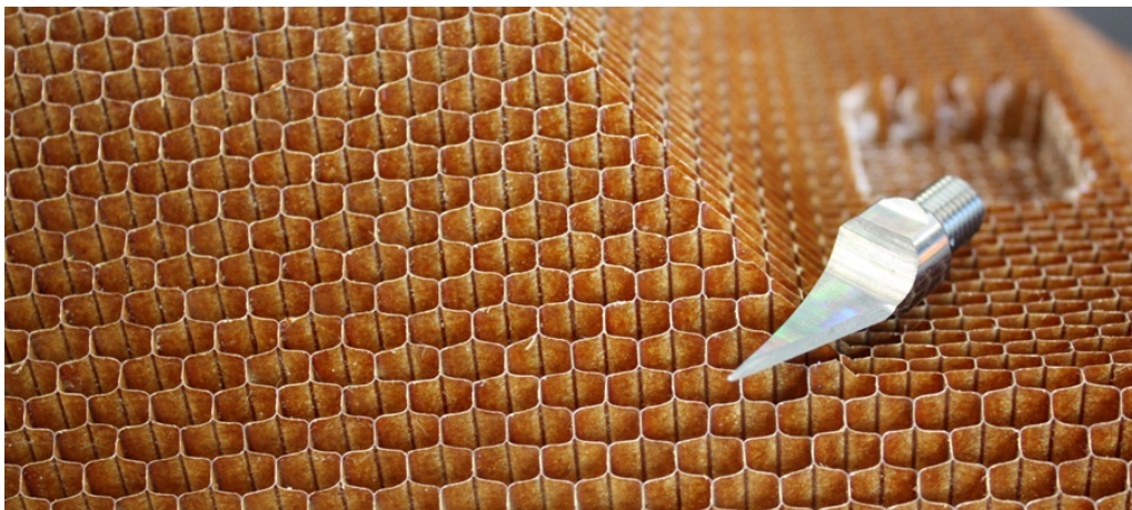
Hufschmied Zerspanungssysteme präsentiert auf der Composites Europe das 5-Achs-Ultraschallschneiden von Wabenmaterial für den Flugzeugbau.
