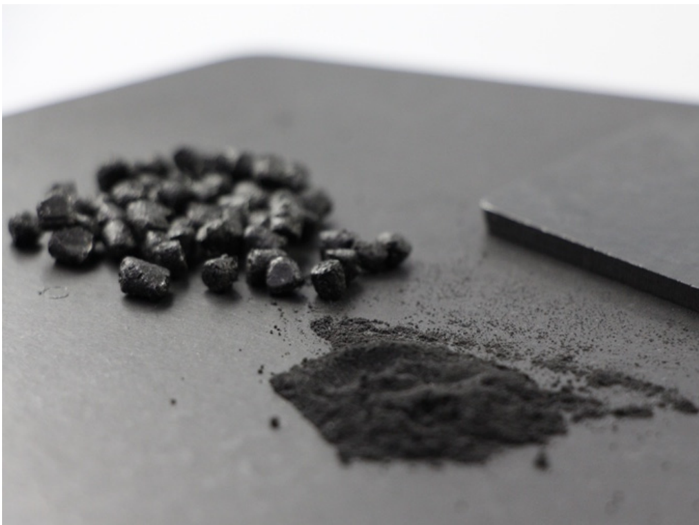
Bipolarplatten aus Polypropylen, modifiziert mit Sekundärgraphit aus rezyklierten C-Fasern
